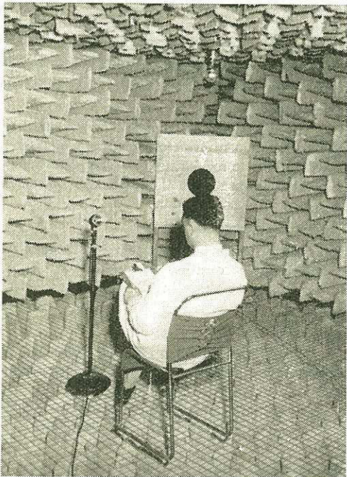
'n Ondersoek van die verstaanbaarheid van spraak in die weerklankvrye kamer. An investigation of the intelligibility of speech in the anechoic chamber.
