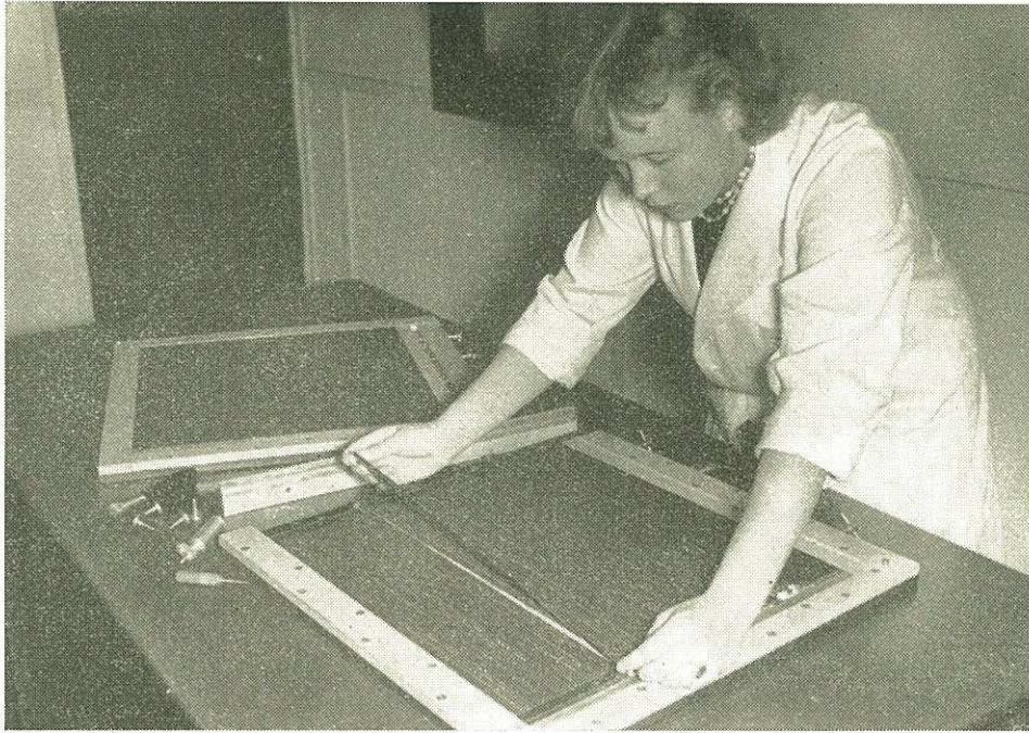
'n Skalogrambord vir die ontleding van gegewens van sielkundige toetse. Met die apparaat kan die gegewens wat met koeëllaers in gaatjies in los aluminiumstrookies uitgeteken word, op 'n paar verskillende maniere gerangskik word.
