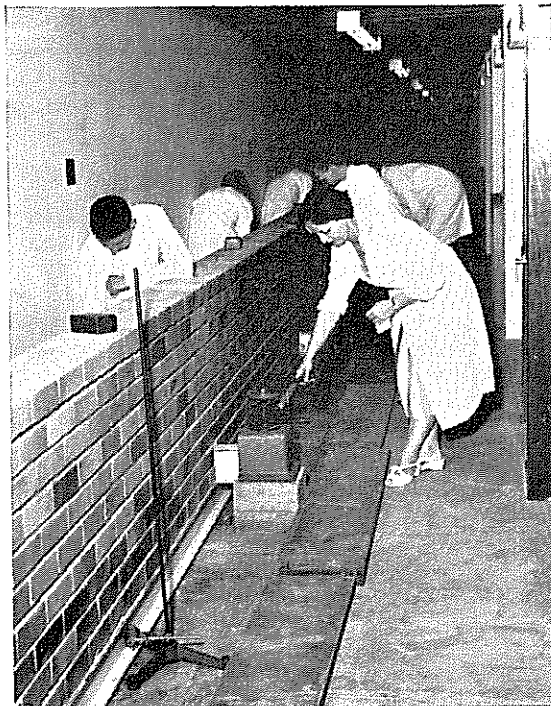
50 Meter optiese bank op vere gemonteer; steunpunte word ingestel
