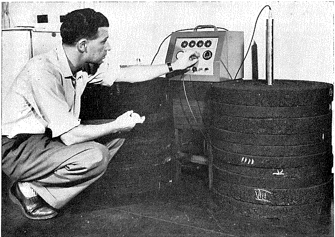
Nasionale Padnavorsingsinstituut: Apparaat om die voggehalte en die digtheid van materiaal met radioisotope te meet
