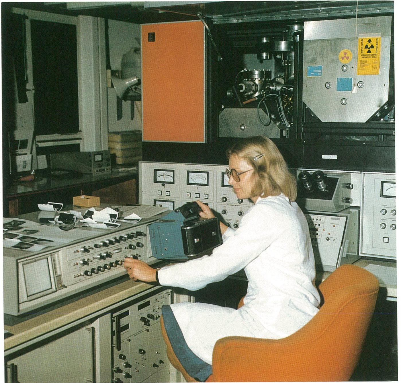
Die ionmikrosondemassa-analiseerder van die Nasionale Fisiese Navorsingslaboratorium is 'n hoogs verfynde instrument wat die oppervlak en naby-oppervlak van vaste stowwe kan ontleed. Areas van slegs 'n paar mikrometer in deursnee kan ondersoek en uitgebeeld word, en alle chemiese elemente (selfs die ligste) kan waargeneem word. Die instrument word by die evaluering van geïntegreerde stroombane en ander toepassings van wetenskaplike en kommersiële belang gebruik.
