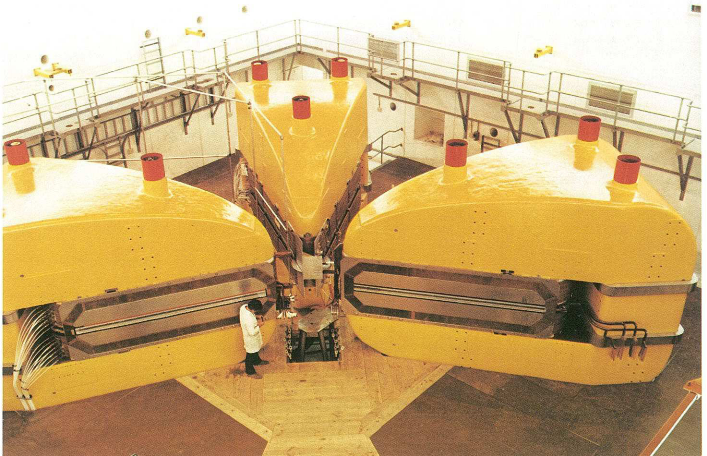
Drie van die vier groot magnete van die oopsektorsiklotron by die Nasionale Versnellersentrum naby Faure, Wes-Kaapland. Die foto is in Junie 1983 geneem.
