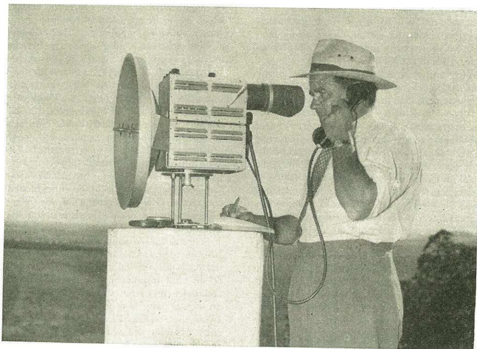
'n Proefmodel van die tellurometer wat gebruik word om die juiste afstand tussen Pretoria en Johannesburg te meet.
